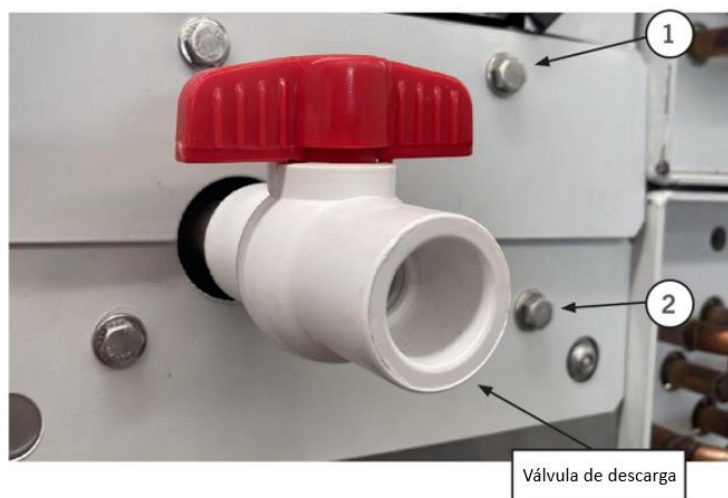
Figura 12 - Imagem da válvula de descarga.
