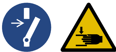
66947 – Revisionsdeckel/Revisionstür: „Vor Arbeiten spannungsfrei schalten“, „Warnung vor Quetschgefahr“
