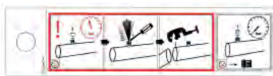
940 – Warnhinweis „Transportfüllung“ am Schraderventil
