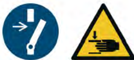
66947 – Pictogrammes d'obligation / d'avertissement Mettre l'appareil hors tension / Avertissement de risque de blessures aux mains
