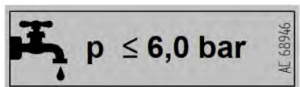
68946 - Limite de pression pour conduite d'eau (avec hydroSPRAY)
