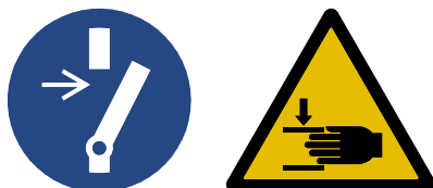
66947 – Revisionsdeckel/Revisionstür: „Vor Arbeiten spannungsfrei schalten“, „Warnung vor Quetschgefahr“
