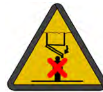
66945 – Warnhinweis „Nicht im Schwenkbereich von Geräten aufhalten“
