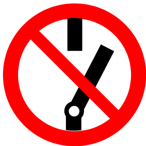
Fig. 2 : Exemple de panneau d'avertissement pour sécurisation contre les réenclenchements
