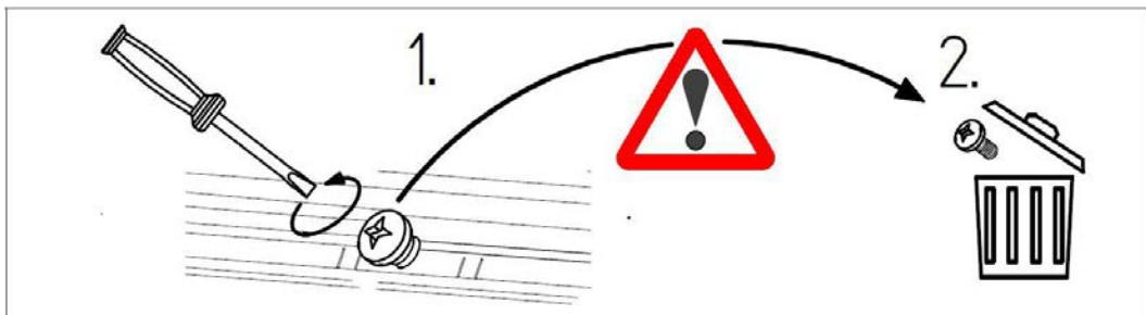
27 – Indicación sobre tornillos de sujeción del bloque
