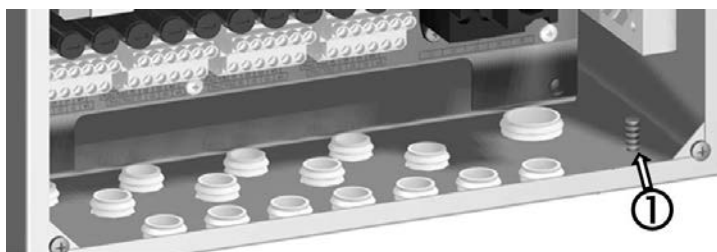
1) Boulon de mise à la terre
