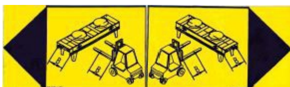
4494 - domeniu de utilizare pentru elevatoare cu săgeți de poziționare; echipamente cu peste 3 ventilatoare
