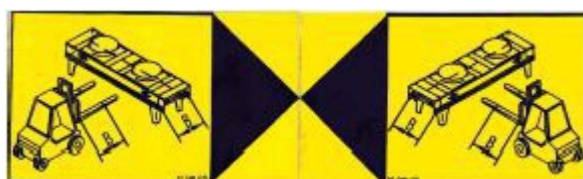
4494 - Область применения вилочных погрузчиков со стрелками позиционирования; устройства до 2 вентиляторов
