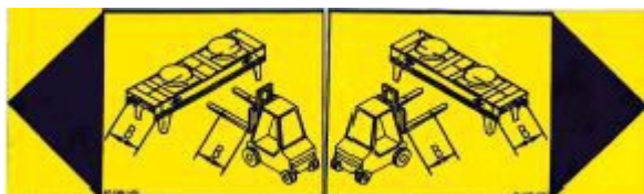
4494 - Oblast pro uchopení vysoko zdvižným vozíkem s šipkami; přístroje se 3 a více ventilátory
