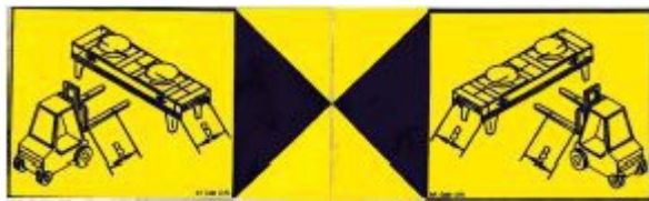
4494 — Наклейка с указанием мест завода вил автопогрузчика и их длины; для устройств с не более чем двумя вентиляторами
