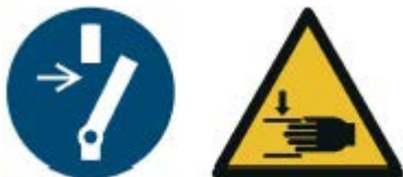
66947 – Utasítást adó jelzés/figyelmeztető jelzés: Szüntesse meg a feszültséget/Figyelmeztetés kézsérülésre
