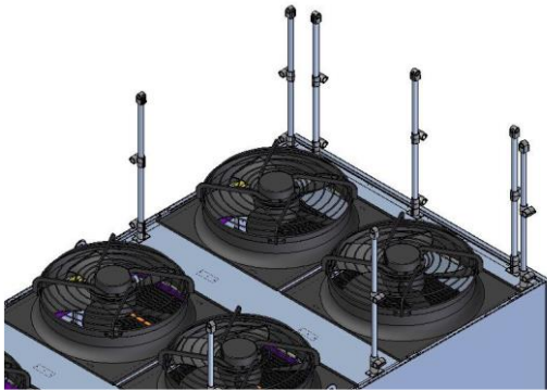
Figura 4: Montagem das colunas do guarda corpo.
